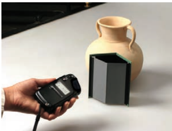
تصویر ۹-۷- نورسنجی بازتابی از کارت خاکستری
