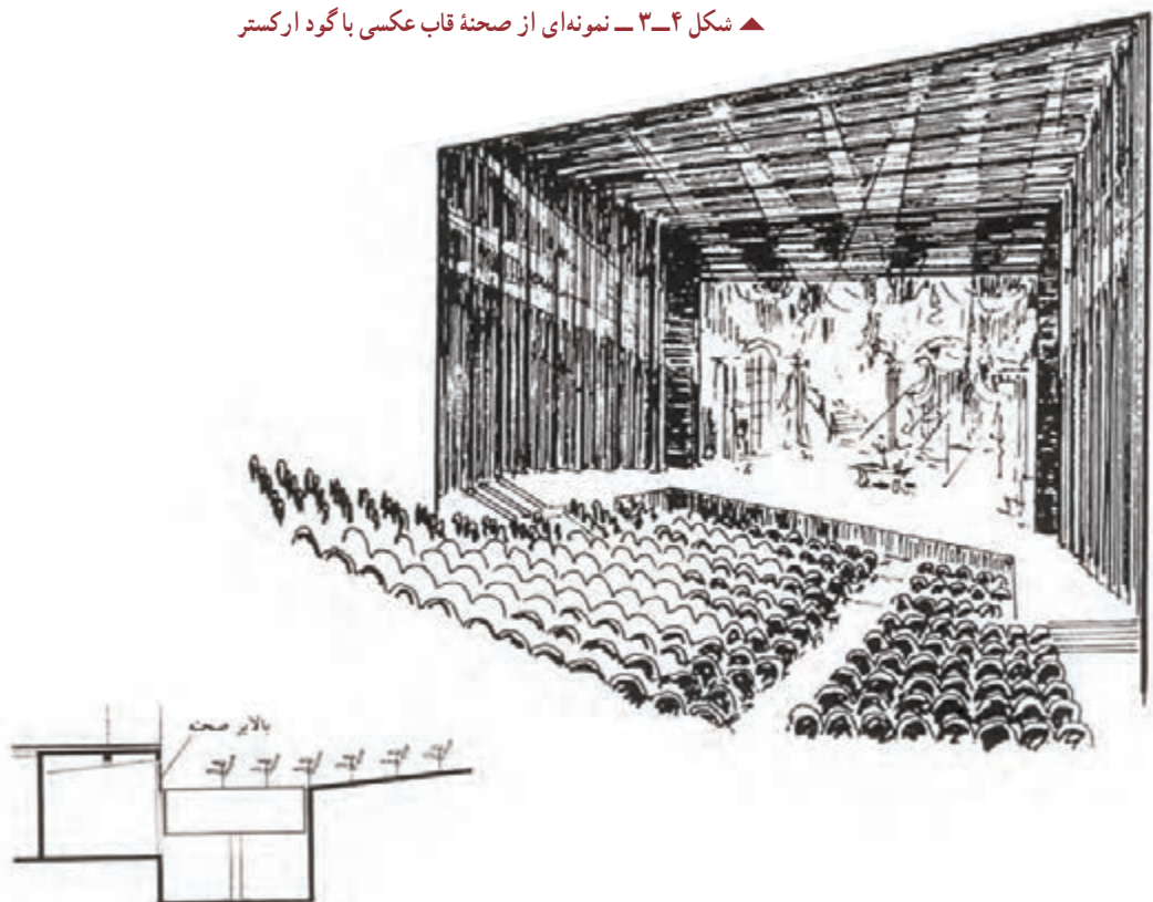
▲ شکل ۳-۵ - نمونه‌ای از صحنه قاب عکسی با پیشروی صندلی تماشاچیان به طرف صحنه (روی گود ارکستر)
