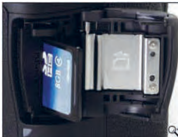
محل نصب کارت حافظه بر روی دوربین
