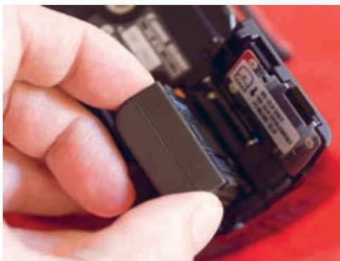
شیوه صحیح نصب باتری دوربین عکاسی
