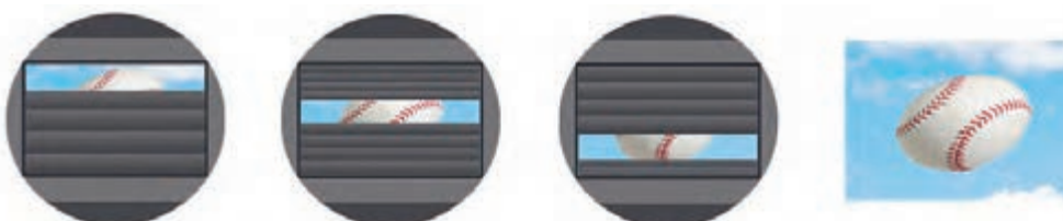
دریافت شکاف نور با استفاده از شاتر در دوربین
