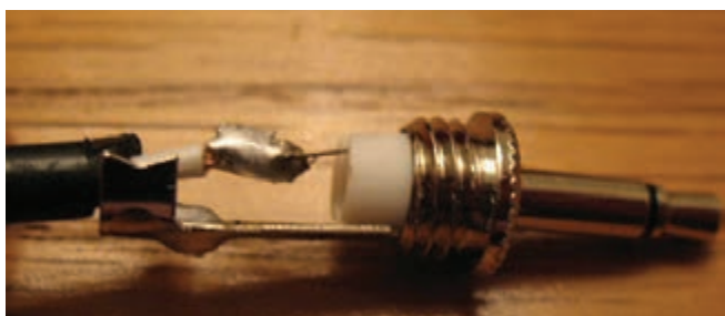
تصویر ۸۵- نقاط اتصال سیستم‌های نان سیمتریک
