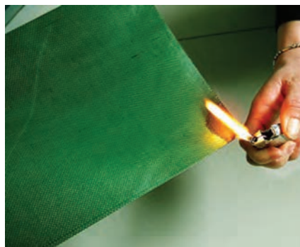
تصویر ۷- نانوپارچه ضد حریق
