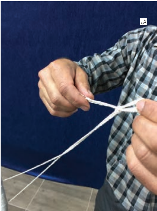
شکل ۳۷-۲- بستن نخ‌های کمکی
