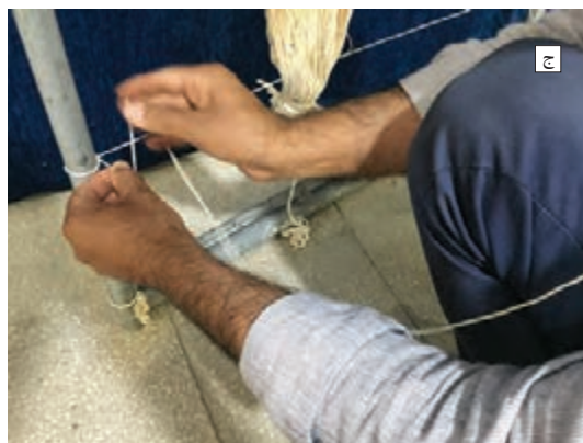
شکل ۷-۳- بازکردن نخ‌های کمکی
