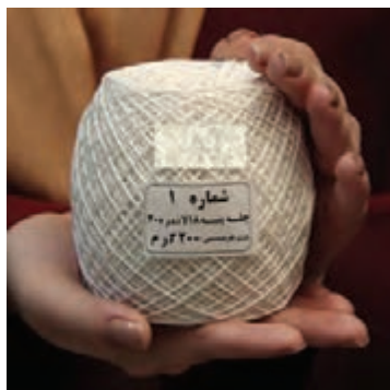
شکل ۱۸-۲-توپک ۲۰۰ گرمی، چله پنبه ای ۱۸ لا نمره ۲۰
