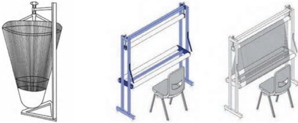
شکل ۱۳-۱ مدلی از دار قالی ارگونومیک
