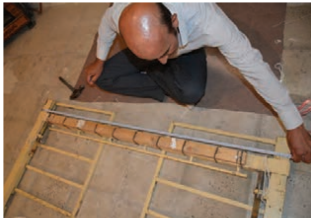
شکل ۱۶-۵ - نصب چوب پایین کشی پشت زیردار
