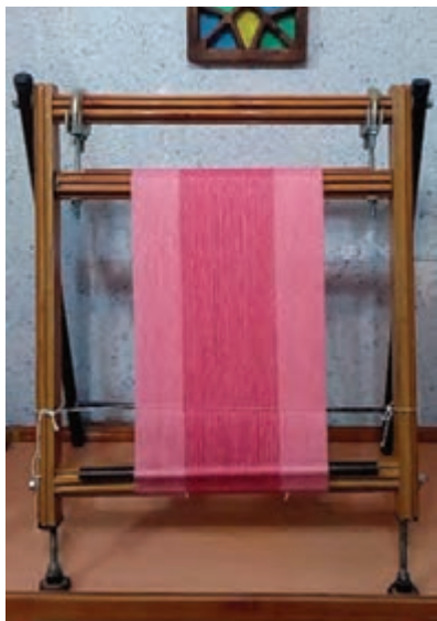
شکل ۱-۴- دار قالی بافی عمودی
