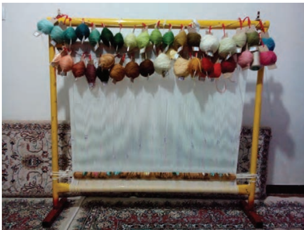
شکل ۶-۱- دار قالی بافی عمودی
