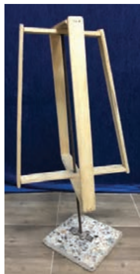
شکل ۲-۲- دستگاه کلاف باز کن
