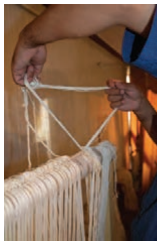
شکل ۱۱-۵ - باز کردن گره‌های سردار
