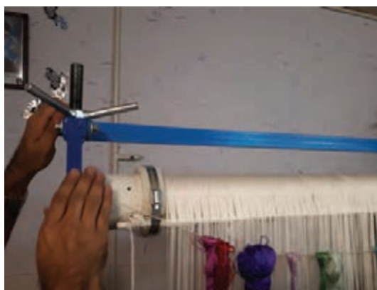
شکل ۳۵-۵ - شل کردن دار
