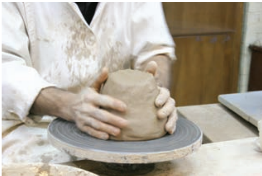
شکل ۸-۴- ب- محکم کردن چانه بر مرکز صفحه
