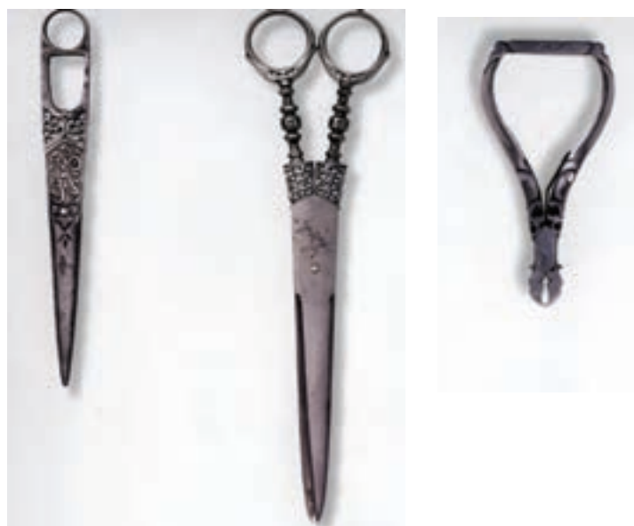
شکل ۷-۶ ب - انواع ابزار و وسایل فلزی ساخته شده به روش ریختگی
