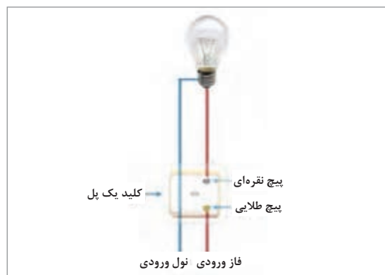
شکل ۳-۳۵- مدار الکتریکی کلید یک پل
