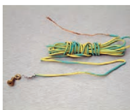
شکل ۳-۱۵ اتصال سیم ارت به بدنه دستگاه‌ها و دوشاخه
