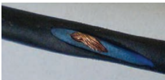
شکل ۱۸-۳- پوسیدگی و زخمی شدن سیم‌ها و کابل‌ها
