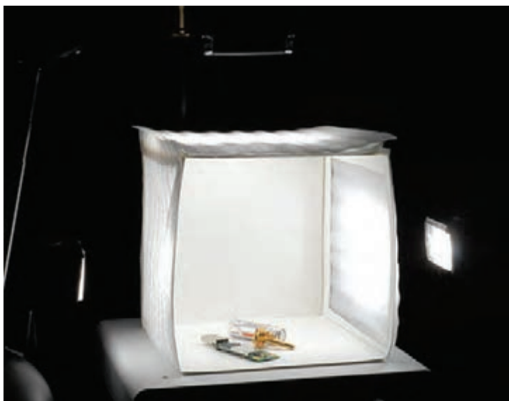
شکل ۳-۲۹- چادر نور برای از بین بردن بازتاب اشياء و تصاویر اشياء بر روی اجسام براق و فلزی به‌هنگام عکس‌برداری
