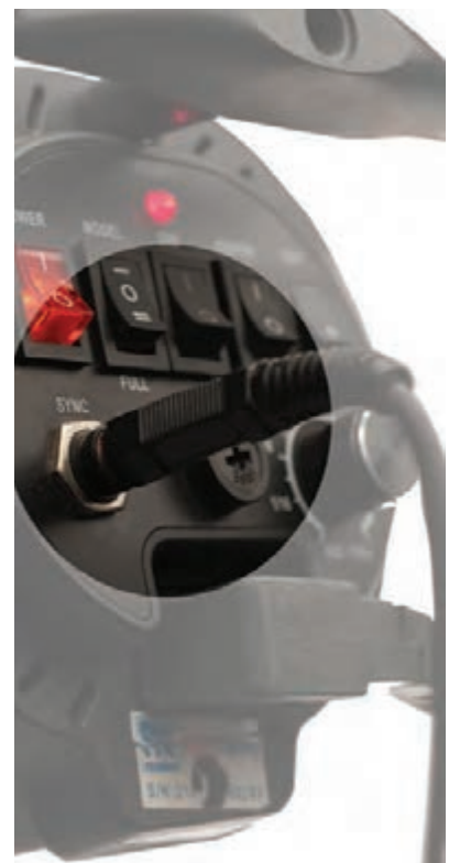
▲ تصویر ۱۹۶ | اتصال سیم سینکرون به فلاش
