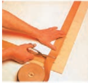
تصویر ۳۵-۲ روش های ثابت کردن کاغذ روی تخته شاسی.
