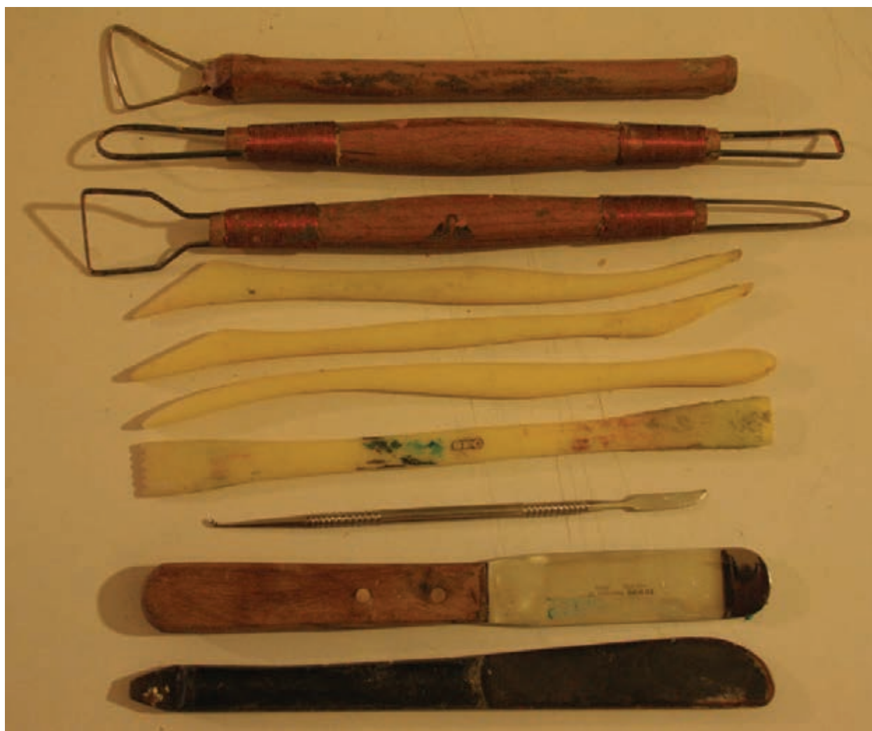
▲ تصویر ۱۶- ابزارهای کار با گِل
