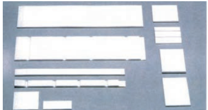
۱- قطعات بریده و زاویه خورده استایروفوم
