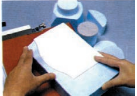
۲- مونتاژ قطعات فومی ساخته شده
