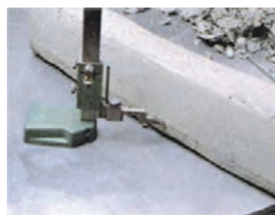
۴- برای اطمینان از تراز بودن خطوط روی مدل از وسیله‌ای شبیه آنچه در شکل آمده است استفاده می‌شود. (کولیس پایه‌دار)
