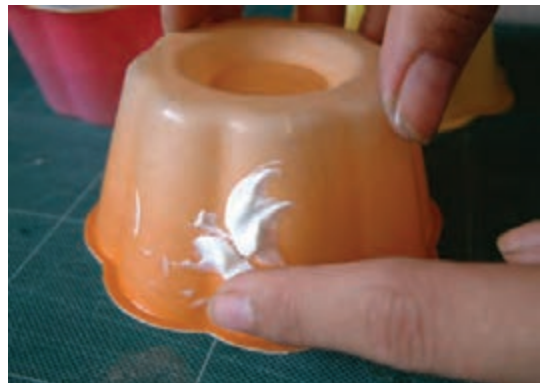
۱- زدن ماده جداکننده به مدل
