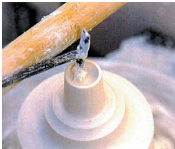
۸- تراش داخلی با استفاده از تکیه‌گاه
