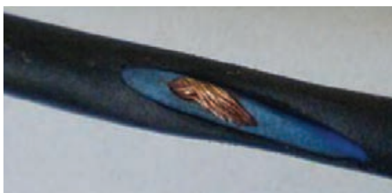
شکل ۱۸-۳- پوسیدگی و زخمی شدن سیم‌ها و کابل‌ها
