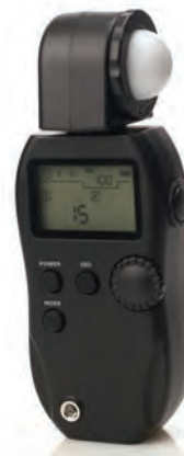
▲ تصویر ۱۸۸ وضعیت کلاهک نورسنج در حالت سنجش ۱۸۰ درجه برای چند منبع نوری همزمان
