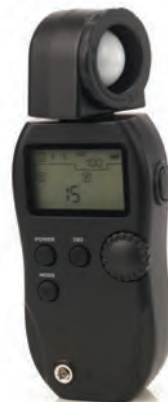
▲ تصویر ۱۸۹ وضعیت کلاهک نورسنج در حالت سنجش نور برای یک منبع نوری
