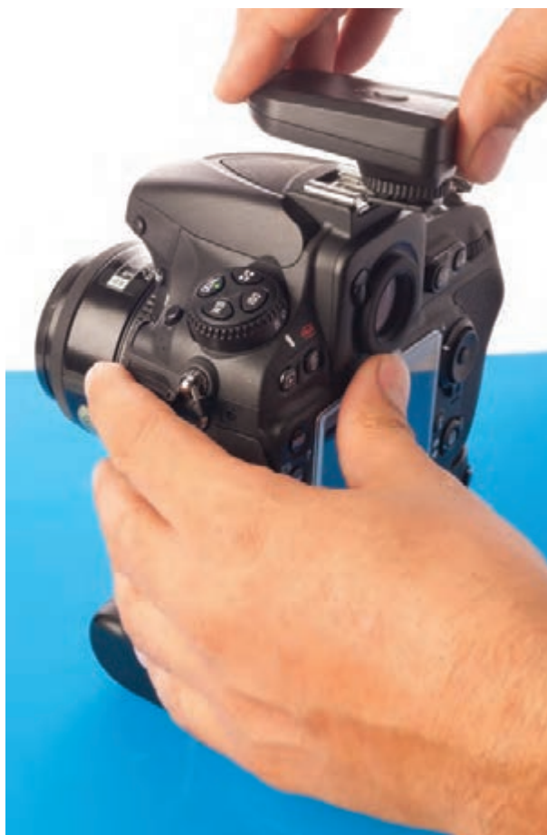
▲ اتصال ریموت فرستنده به دوربین | تصویر ۱۳۵
