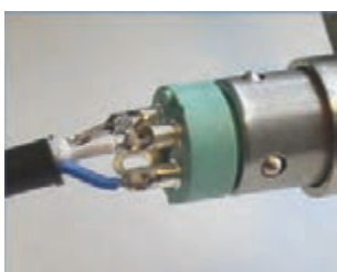
تصویر ۷۶- نقاط اتصال سیستم‌های سیم‌تریک
