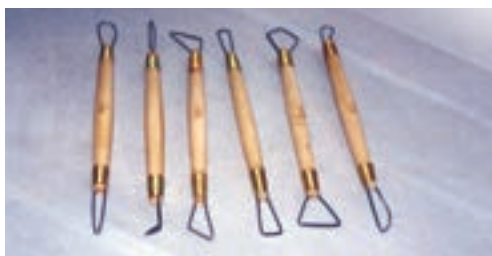
شکل ۴-۶- برخی از ابزار تزیین بدنه‌ی گلی- ابزار بردارنده (کاهنده)
