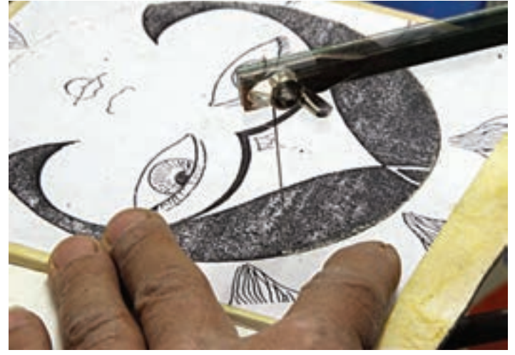
شکل ۸-۲۰ الف - طرح کاغذی چسبانده شده بر قالب یا تخته سه لایی
