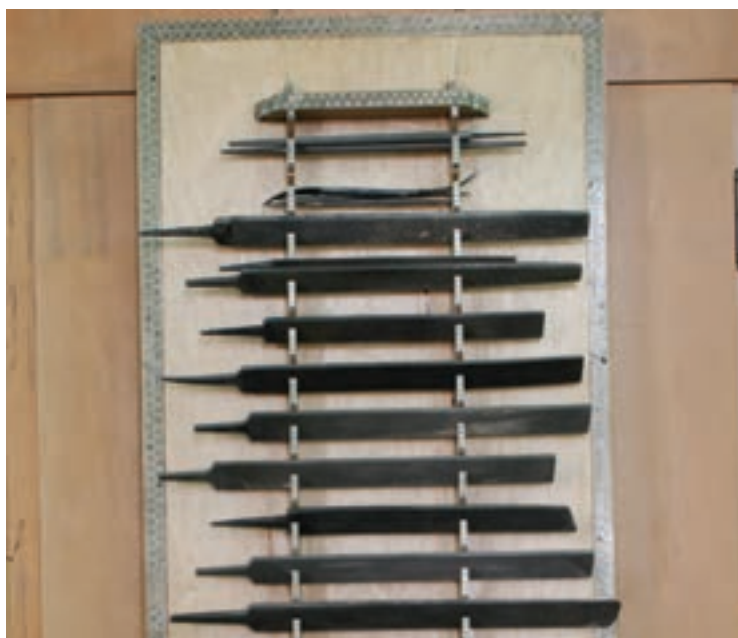
انواع سوهان (از ابزار سایش و پرداخت)
