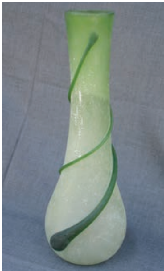
گلدان شیشه‌ای مات شده به وسیله‌ی غلطاندن در پودر سیلیس
