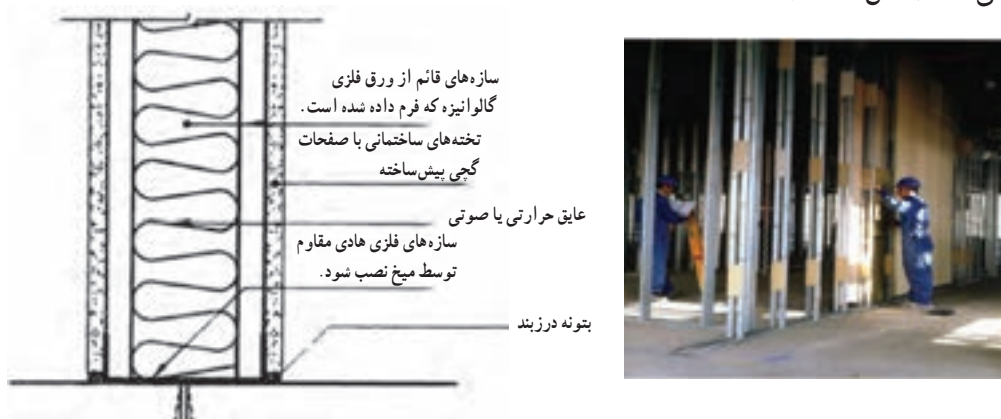
شکل ۱۵-۴ جزئیات دیوار مرکب با پوشش صفحات گچی و نحوه ی اجرای آن
