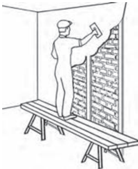
شکل ۸-۵- طریقه‌ی گچ کاری دیوار
