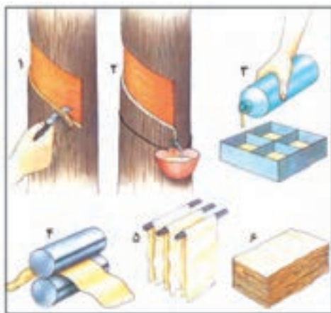
شکل ۱۴-۲- نحوه‌ی تهیه لاستیک طبیعی
