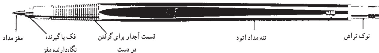
شکل ۷- مداد اتود و قسمت‌های مختلف آن
