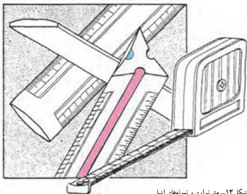
شکل ۱۳- متر نواری و نمونه‌های اشل
